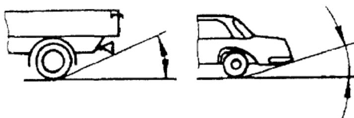
Рисунок 2. Угол съезда
